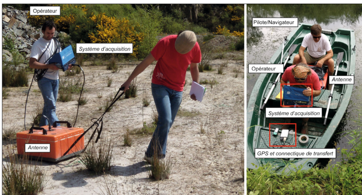
Figure 2. Exemple d'utilisation du radar géologique a) en milieu terrestre; b) en milieu aquatique. Pour les deux essais, le système d'acquisition utilisé est un SIR 3000 connecté à une antenne de 200 MHz, développé par la société GSSI
